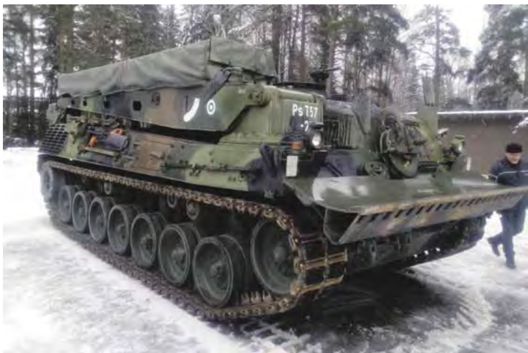
Leopard 1 -evakuointipanssarivaunu. Raivausvaunusta sen erottaa pienempi puskulevy.
