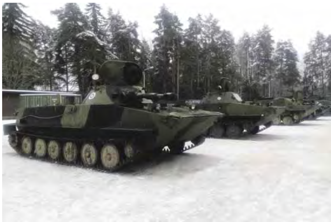
PT-76 -tiedusteluvaunu ja sen ajokoulutusversio. Jälkimmäisessä tykin paikalla on pleksi-ikkuna.
