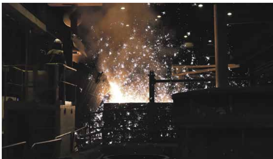
Sula rauta valuu muottiin tehtaan valimossa.
