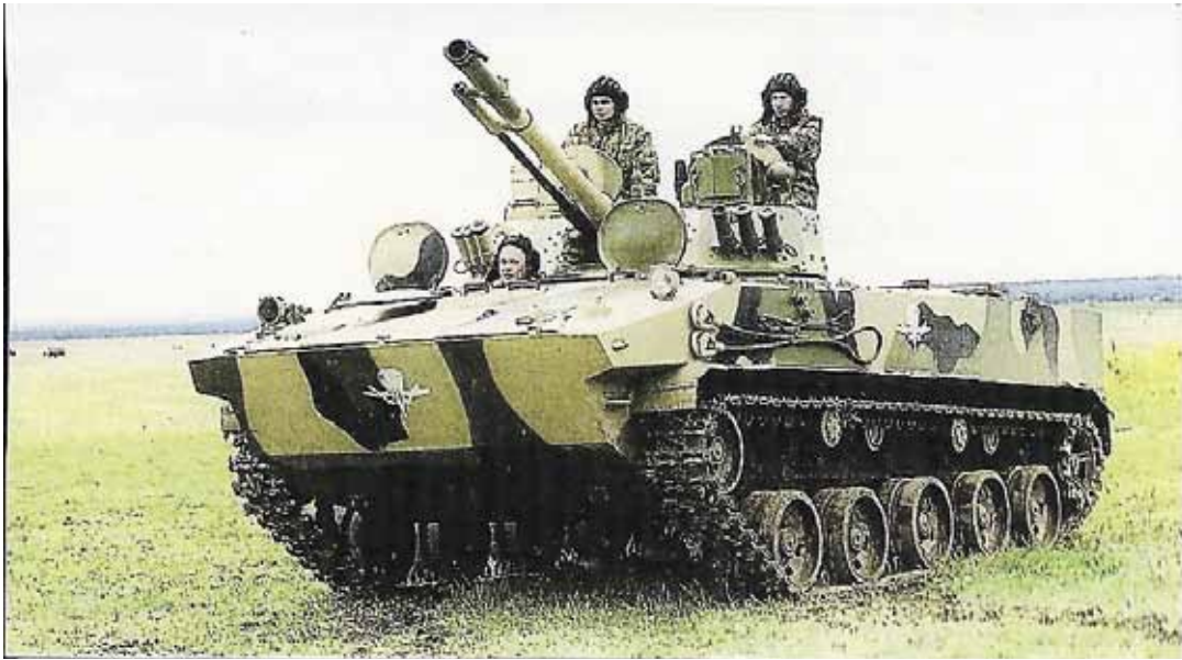
Maahanlaskujoukkojen uusi rynnäköpanssarivaunu BMD-4M, aseina 100 mm:n sekä 30 mm:n kanuunat, miehistöä on 3 ja vaunu kuljettaa 4-5 sotilasta.
